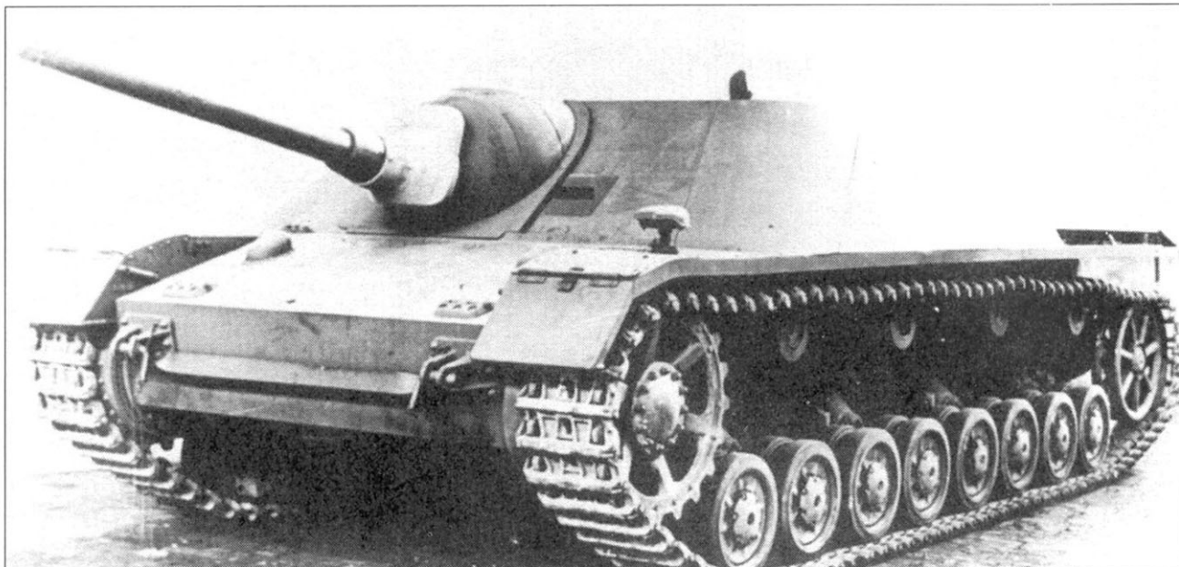
Первый прототип Jagdpanzer IV, собранный на шасси танка Panzer IV Ausf. F.
