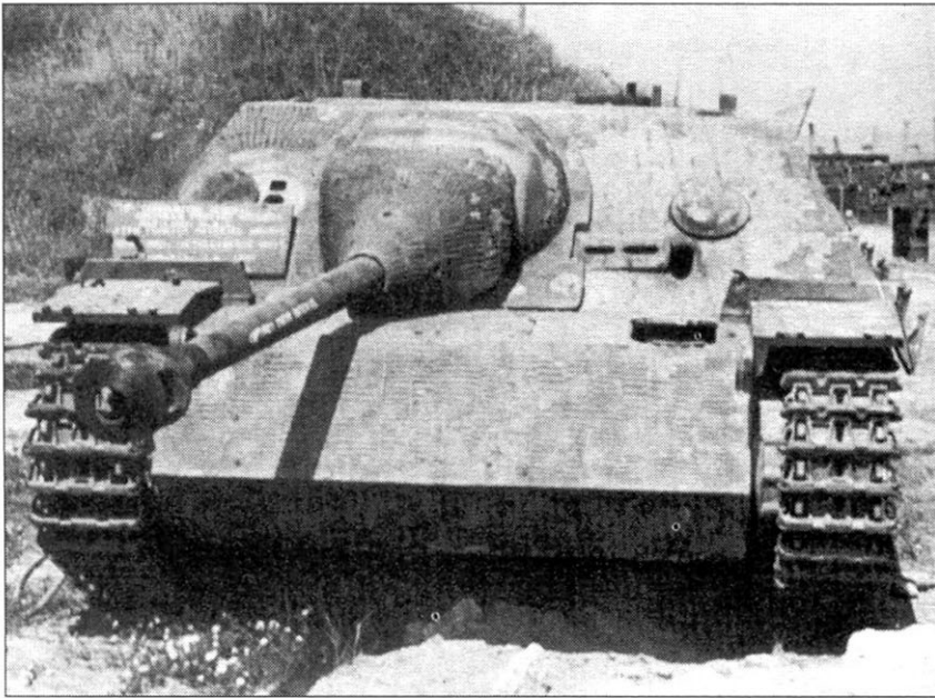
Четыре фото потерянного в Италии Jagdpanzer IV из дивизии «Hermann Goering», машина выпущена в марте/апреле 1944 года. Ствол с дульным тормозом, запасные траки перенесены на корму. Левая бойница заварена заглушкой. Рядом со смотровым прибором механика-водителя видно сквозное отверстие от броневой снаряда.
