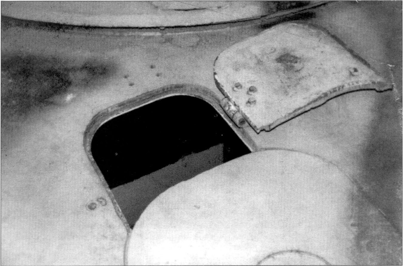
Лючок для перископа в открытом и закрытом положениях.
