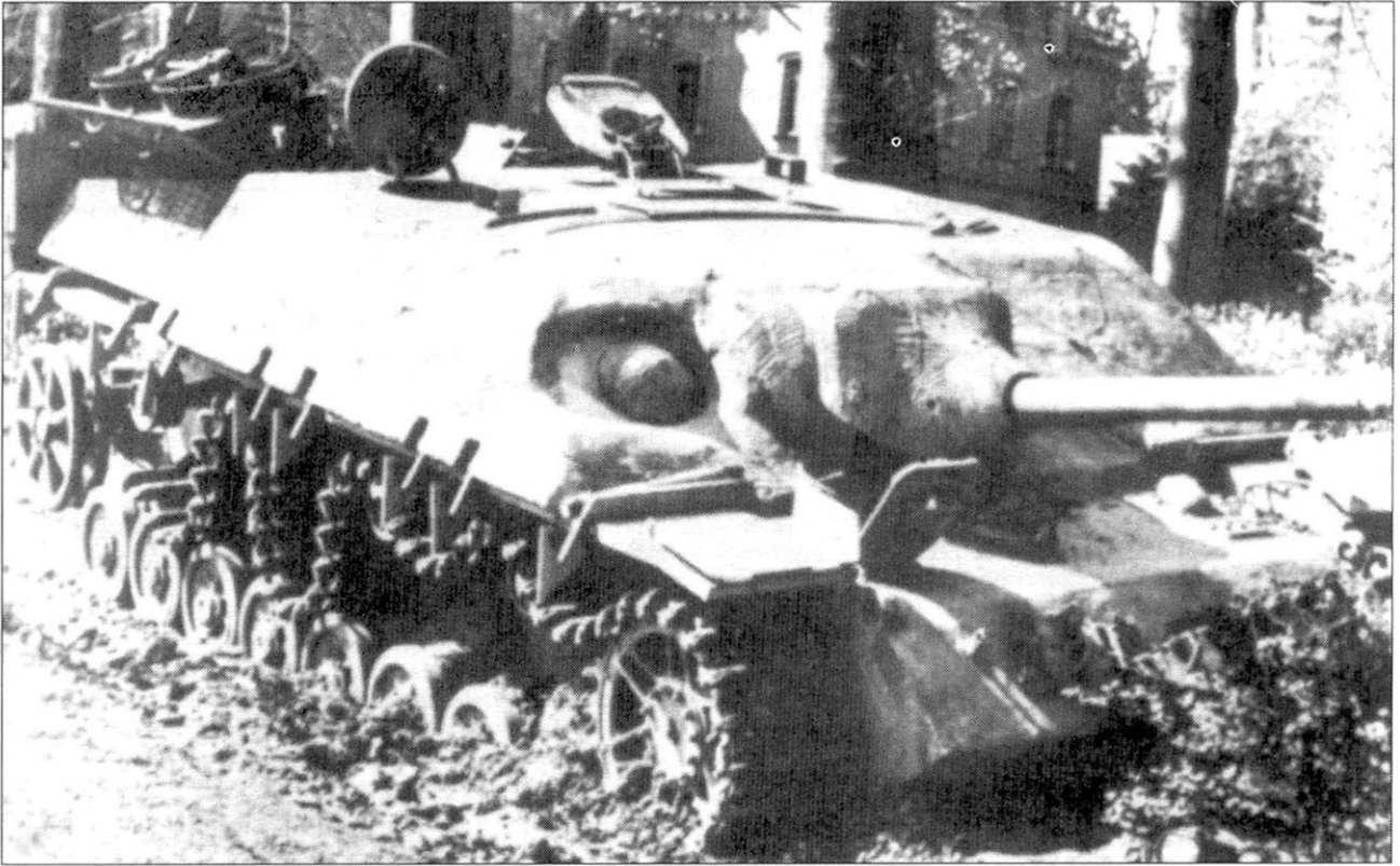
Уничтоженный Jagdpanzer IV SdKfz 162 из неизвестной части, Германия, весна 1945 года. Лобовая и бортовая броня усилены бетоном.
