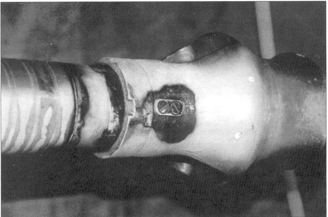
Дульный тормоз пушки. Хорошо видны болты крепления.
