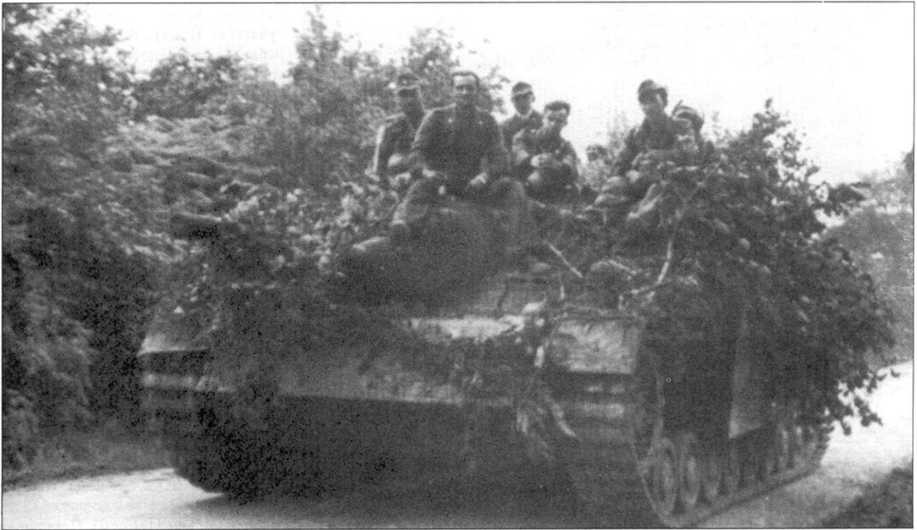
Самоходный истребитель танков Jagdpanzer IV SdKfz 162 из неизвестной части, Нормандия, июнь 1944 года. Машина увешана листвой и напоминает большой куст - во время налета авиации союзников такому танку достаточно съехать на обочину шоссе и он станет почти незаметен на фоне растительности. Ствол пушки закрыт брезентовым чехлом, часть бортовых экранов потеряна.
